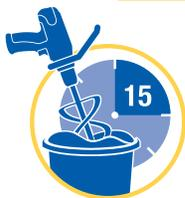
3. Deje reposar la mezcla entre 10 y 15 minutos y mézclela preferiblemente con un agitador mecánico.
